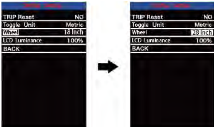
Einstellung des Raddurchmessers
