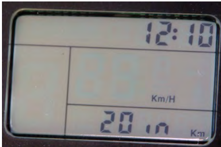
Max. Einstellung (max. 25 km/h)
